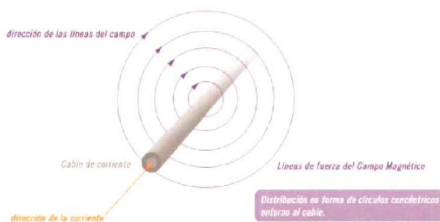
Líneas de fuerza del campo magnético en un cable de corriente.
